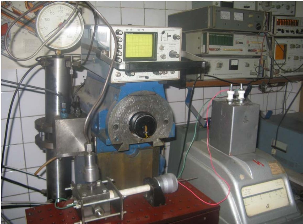
Рисунок 4 – Лабораторный образец (макет) установки ЭГ-насоса.
